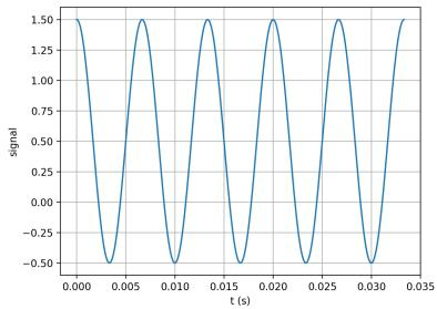
▷ somme de deux signaux sinusoïdaux ( $\omega_1 < \omega_2$ ) :  $s(t) = S_0 \cos(\omega_1 t) + 0,2S_0 \cos(\omega_2 t)$
