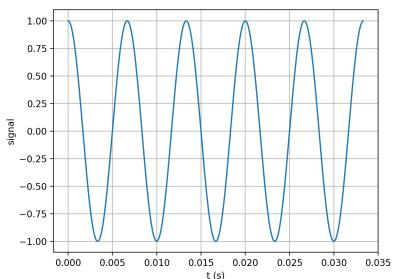
▷ signal sinusoïdal avec une composante continue :  $s(t) = S_m + S_0 \cos(\omega_e t)$
